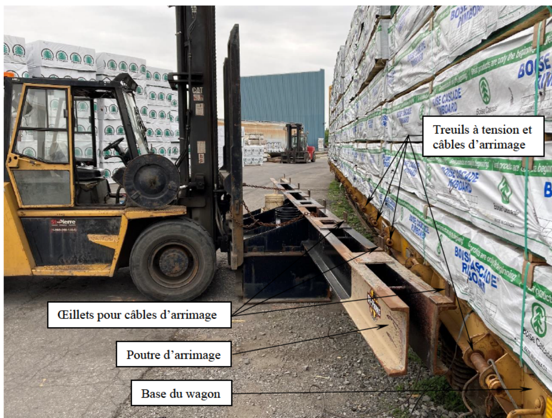
Fig. 7 – Composantes de la procédure d'arrimage
