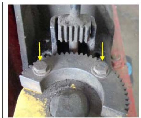
Photos 22. Boulons de fixation des engrenages des barrures. Le motif sur la tête indique qu'il s'agit de boulons de grade 8.
