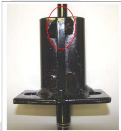
Photo 6. Barre de renfort plus longue sur le nouveau modèle de barrure de 2014.
