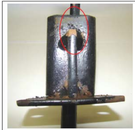
Photo 5. Barre de renfort plus courte sur l'ancien modèle de barrure de 2003.
