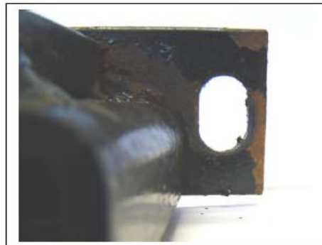
Photo 12. Trous de fixation ovales à la base de l'ancien modèle de barrure 2003.
