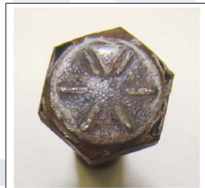
Photos 22. Boulons de fixation des engrenages des barrures. Le motif sur la tête indique qu'il s'agit de boulons de grade 8.
