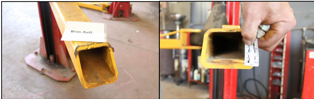
Figure 13 : Plaque à l'intérieur du bras de levage 1
