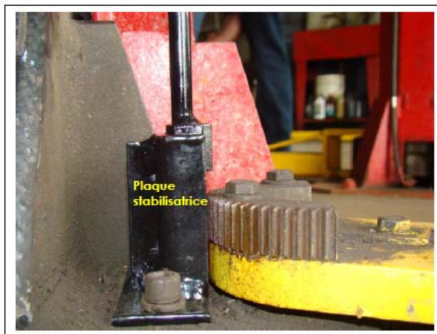
Photo 18. Plaque stabilisatrice non déformée.
