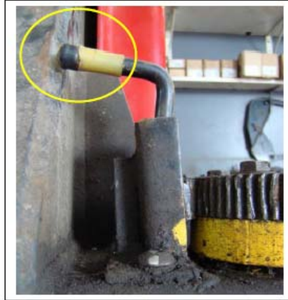
Photo 4. Contact poignée et structure. Ci-haut, une barrure similaire en service.
