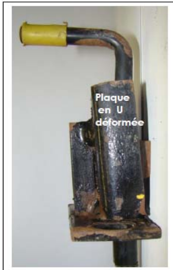
Photo 20. Plaque stabilisatrice déformée.
