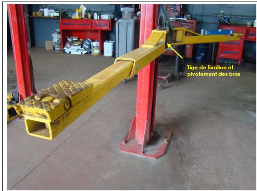
Photo 14. Emplacement de la tige de fixation et pivotement des bras du système de levage.
