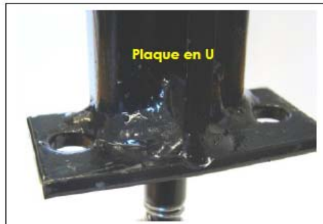
Photo 7. Plaque en U soudée sur toute sa base sur une barrure 2014.
