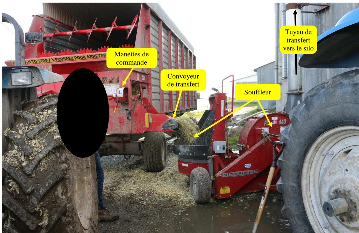
Figure 6 : Équipements utilisés pour le transfert du contenu de la boîte d'ensilage vers le silo
