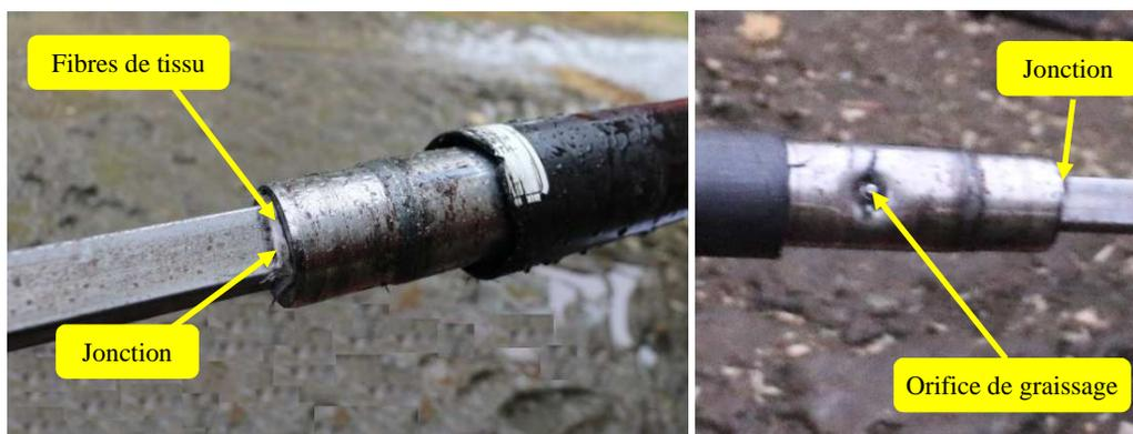
Figure 12 : Jonction des deux parties de l'arbre de transmission rétractable
