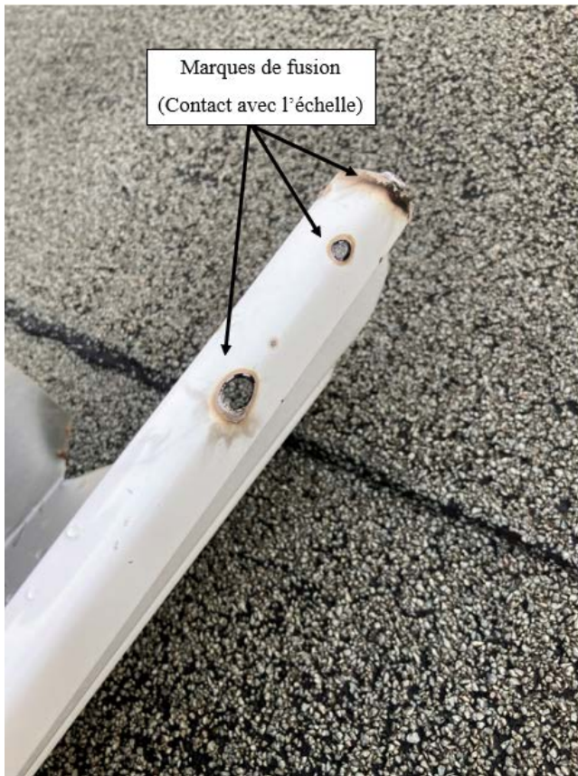
Fig. 5 - Photographie des marques de fusion à l'extrémité en contact avec l'échelle Source : CNESST
