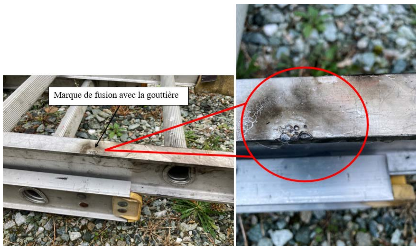
Fig. 7 - Photographie de la marque de fusion au contact de la gouttière sur l'échelle
