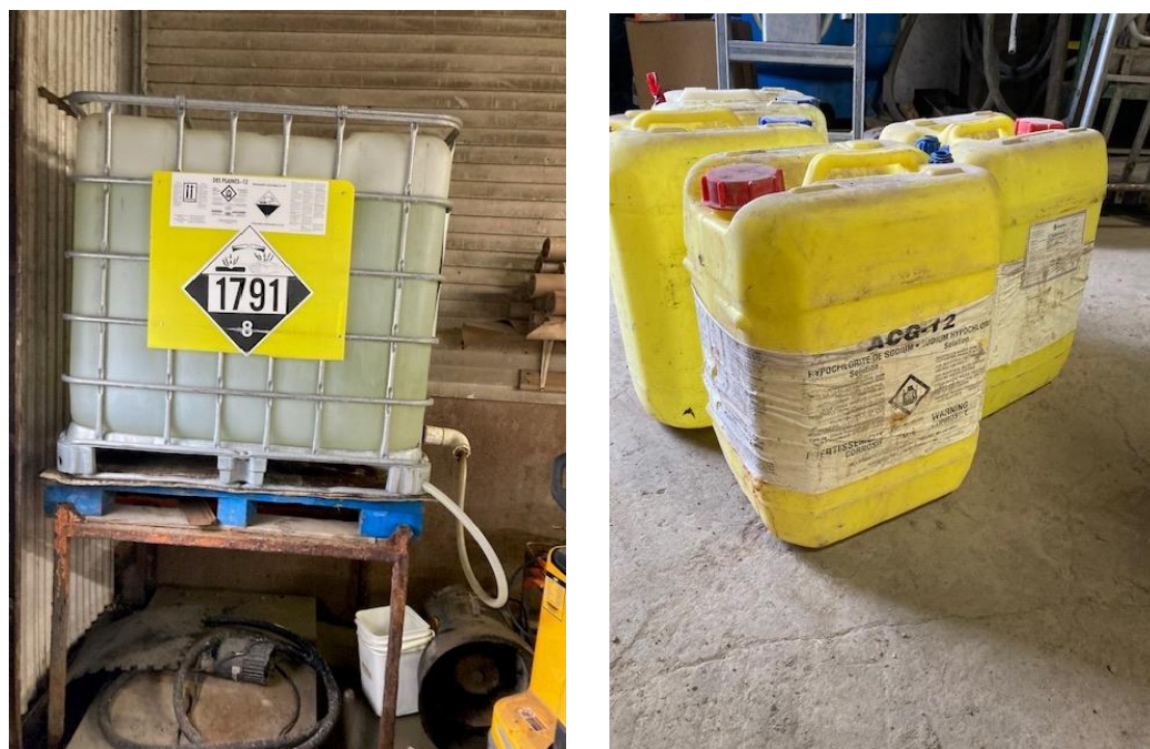
Fig. 9 et 10 - Photographies des contenants de 1000 l et 20 l du désinfectant Source : CNESST
