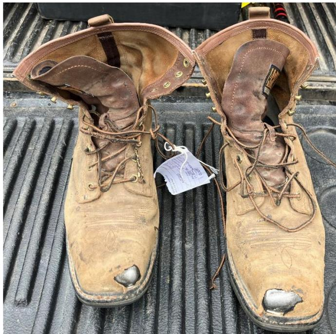
Fig. 10 – Chaussures en cuir à embout d'acier
