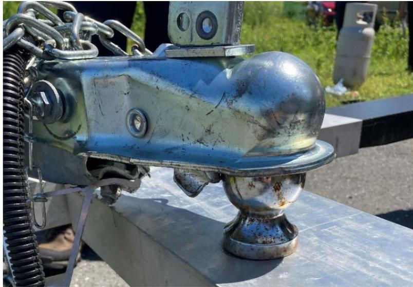
Fig. 5 : Exemple d'insertion d'une boule dans la tête d'attelage
