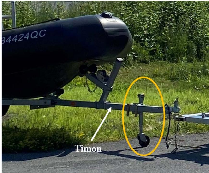
Fig. 7 : Roue support (encerclée) et le timon
