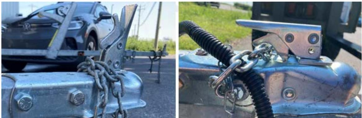
Fig. 6 : Levier de verrouillage ouvert (gauche) et levier de verrouillage fermé (droite)
