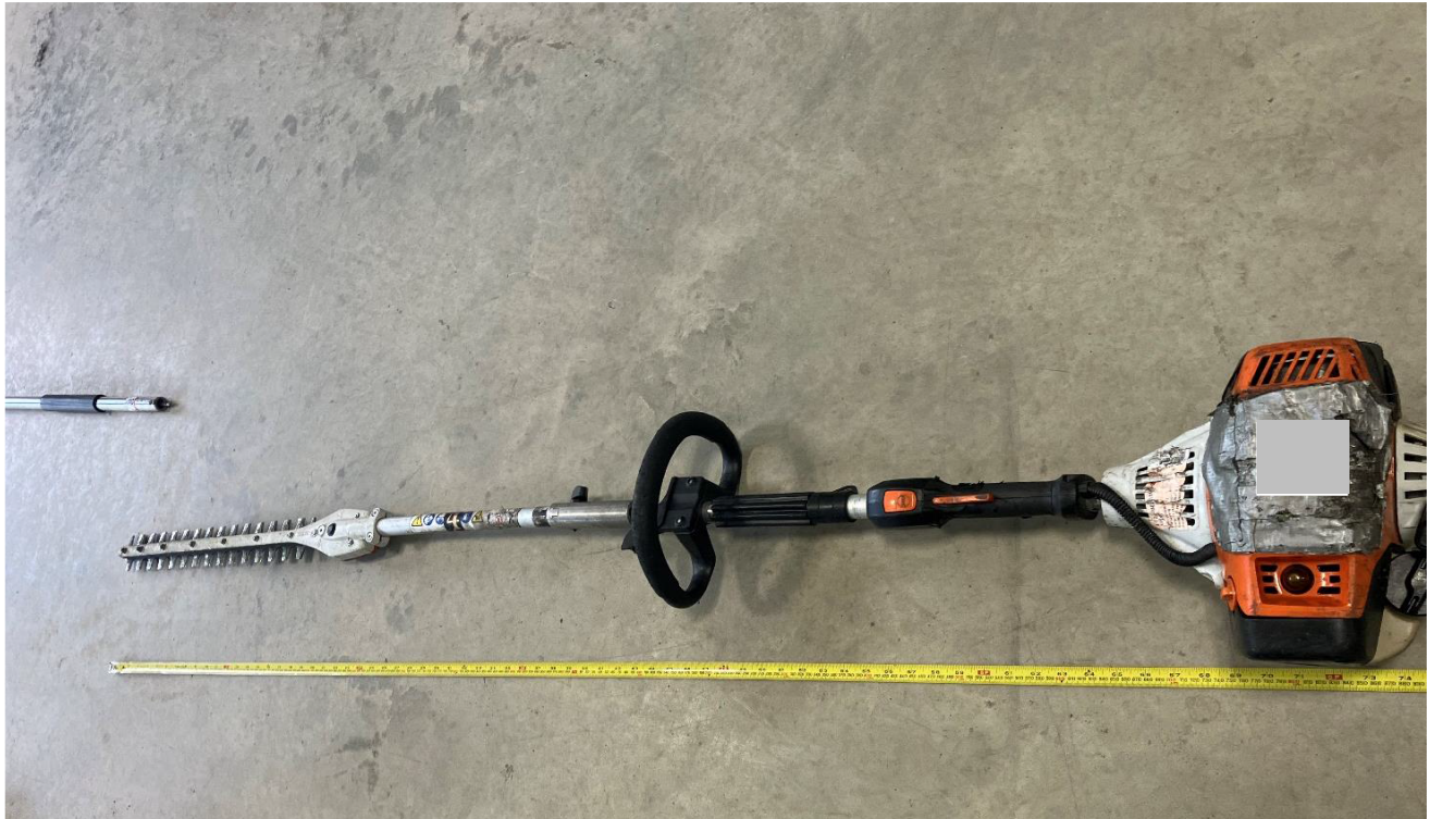
Fig. 7 - Taille-haie de marque STIHL, modèle KM 131 Source : CNESST
