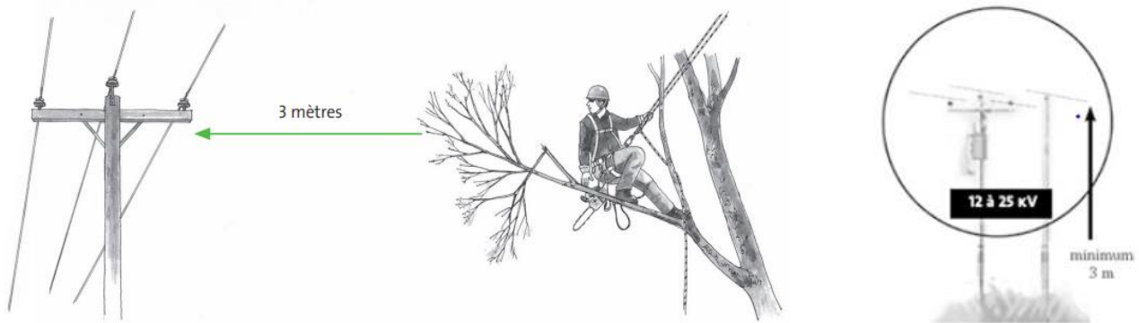
Fig. 11 - Représentation de la distance d'approche minimale pour une ligne électrique ayant une tension de 14,4 kV
