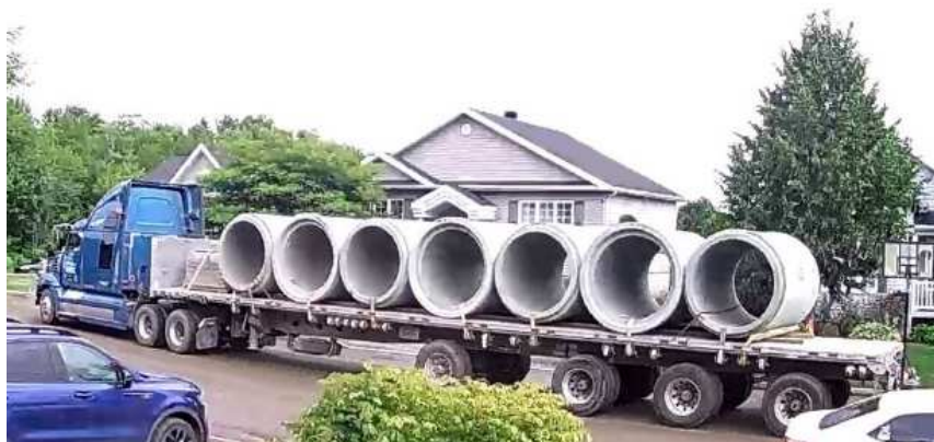
Fig. 7 – Livraison de conduites de béton Source : citoyen (modifiée par la CNESST)
