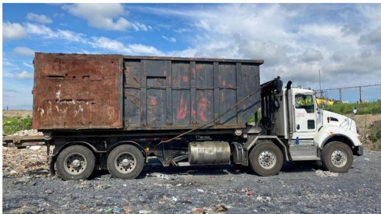
*Fig. 7 – Porte-conteneur Mack modèle GU813 et dispositif de porte-conteneur Technifab modèle ROT-6526*
