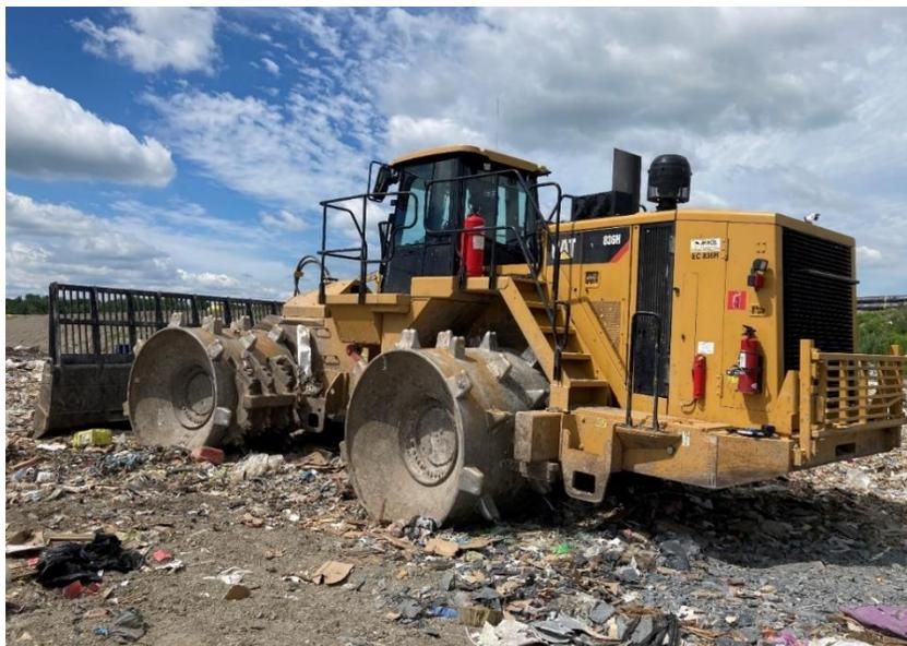
Fig. 6 – *Compacteur à déchets Caterpillar, modèle 836H*
